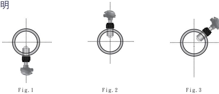
Fig.1: 可安裝於無沉澱物的流體管路
